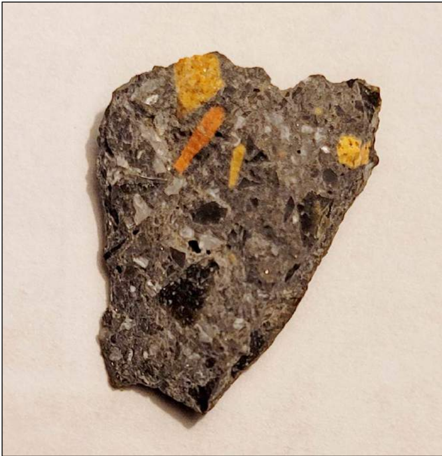
Fragment tynku kamieniarskiego, zdjętego w miejscu ubytku w cokole, fotografia w powiększeniu. Widoczne grysiki kolorowych marmurów.
