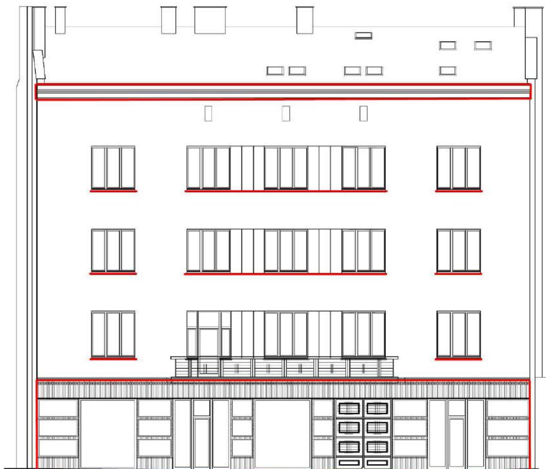
Rzut elewacji - zaznaczone elementy dekorowane tynkiem kamiennym
